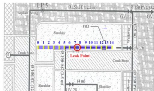
รูปที่ 4-3 การกำหนดแนวทดสอบและจุดรั่วไหล
