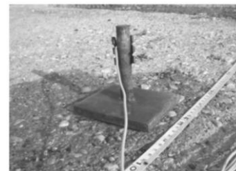
รูปที่ 2-9: อิเล็กโทรดแบบแบนขนาด 7x7 เซนติเมตร
