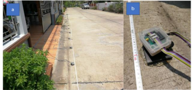
รูปที่ 4-7 (a) การกำหนดแนวทดสอบ และ (b) การใช้แผ่นเหล็กอิเล็กโทรดร่วมกับเจลนำไฟฟ้า
